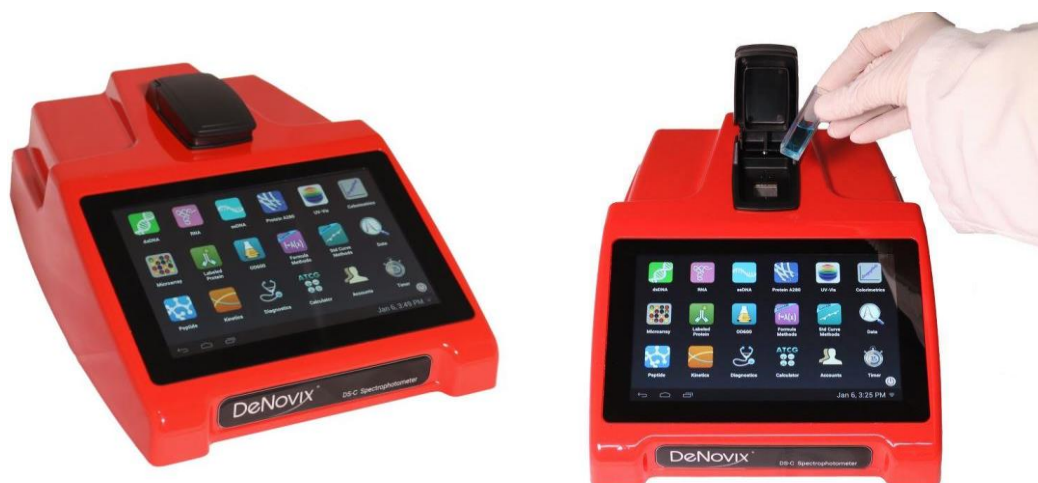
Рис.6.12. Спектрофотометр з кюветним відділенням та сенсорним дисплеєм «DS-C», DeNovix
