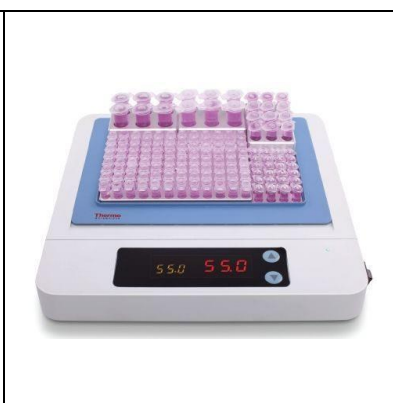
Рис.6.8. Цифровий термостат «CompactDryBath S», ThermoFisher Діапазон робочих температур +2 – +100 °С, точність ≤ ±0,5 °С, наявні різні комбінації змінних блоків для пробірок різного об'єму від 0,2 мл до 50 мл
