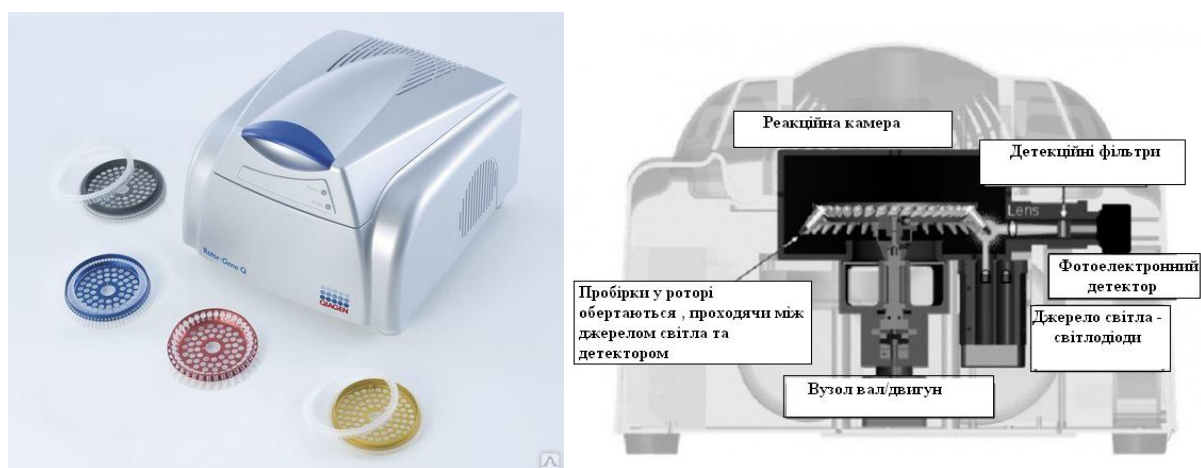
Рис. 6.24. Ампліфікатор роторного типу Rotor-Gene Q, Qiagen
