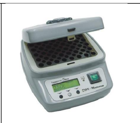
Рис.6.9. Твердотільний термостат «Гном», ДНК-Технологія Діапазон робочих температур від кімнатної до 99 °С, точність ±0,5 °С, формат блоку: для пробірок на 1,5 мл – 40 місць, для пробірок на 5 мл – 28 місць. Оснащений теплоізолюючою притискною кришкою для рівномірного нагрівання та запобігання відкривання кришок пробірок
