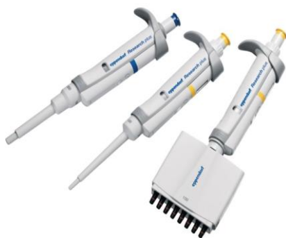
Рис. 6.15. Ручні механічні одно- та восьмиканальні дозатори змінного об'єму, Eppendorf
