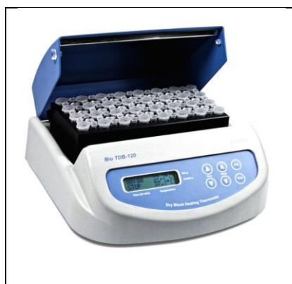
Рис. 6.7. Цифровий твердотільний термостат «TDB-120», Biosan Діапазон робочих температур +25 – +120 °С, точність ±0,1 °С, з алюмінієвим блоком А-103 для мікропробірок 1,5 мл (32 місця), 0,5 мл (21 місце) і 0,2 мл (50 місць)
