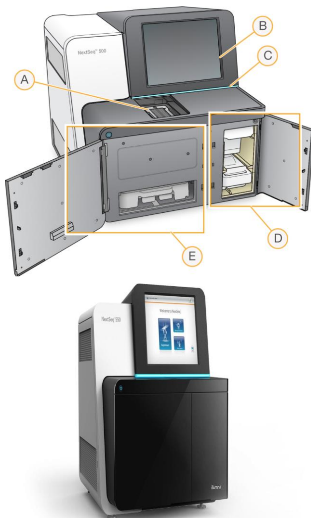
Рис. 6.31. Сканер мікрочіпів ДНК/РНК NextSeq 550, Illumina A – відділення для зразків або мікрочіпів; B – монітор; C – лінія стану роботи приладу – вказує на становище інструменту: робочий (синій), вимагає уваги (помаранчевий), готовий до секвенування (зелений) або вимкнеться у наступних 24 години (жовтий); D – відсік для картриджів з буферним розчином; E – відсік для картриджів з реагентами
