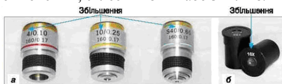
Рис. 6.6.2. Об'єктиви (а), окуляр (б) та їх маркування
